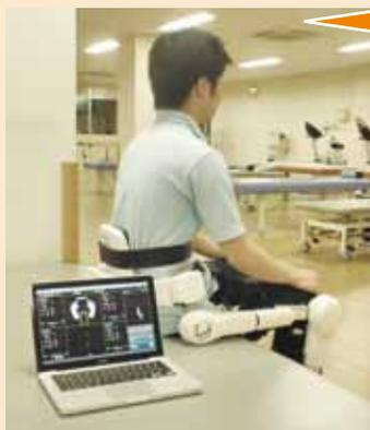
▶ 股関節屈筋・伸筋および膝関節屈筋・伸筋に「HAL」の電極を貼り付け、股関節・膝関節の動きをコンピュータ制御にてコントロールします。動かしにくい股関節・膝関節に対し、介助をします。これにより、麻痺側下肢、筋力低下をおこした下肢に対して、サポートを加え、リハビリテーション室職員の指導のもと障害の克服に努めて頂きます。
