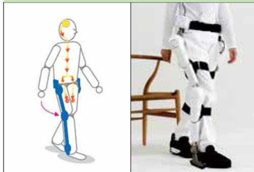
以上のように脳からの生体信号に応じて、筋肉が収縮し、足の筋肉の弱い部分を補い、介助してくれるのがHALであり、HALを用いて立つ動作、歩く動作の自立獲得が目標となります。
