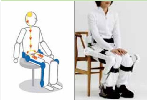
人が動くとうすると脳からの指示で、筋肉が収縮し電気信号を出します。
