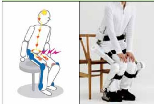
その電気信号が、皮膚に貼りつけたセンサーにより反応を示します。
